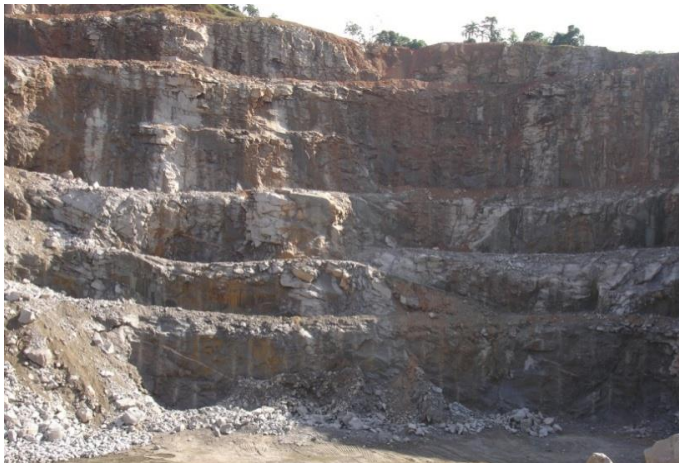
Foto 9 – Pedreira Massaguaçu (LN – 09) em Caraguatatuba: vista parcial da frente de lavra em rochas gnaissicas.
