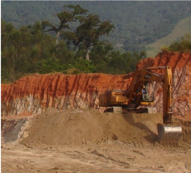
Foto 1 – Mineração Pegorelli – Caraguatatuba (LN – 06): Observar os dois tipos de minério lavrado – solo areno-argiloso avermelhado e sapropelito cinza esbranquiçado. Notar escavadeira hidráulica, equipamento usual nas lavras de material de empréstimo.
