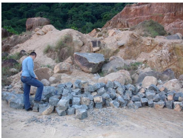
Foto 8 – Mineração Cabral de Ubatuba (LN – 02): rocha charnockítica desdobrada em paralelepípedos – subproduto em lavra de saibro.
