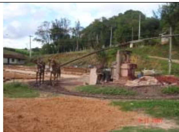
Foto 22 – Pipa movida à tração animal utilizada na mistura das matérias-primas.
