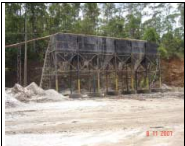
Foto 3 - Silos de armazenagem de areia em área de expedição do produto (Extratora de Areia Carmo Messias).
