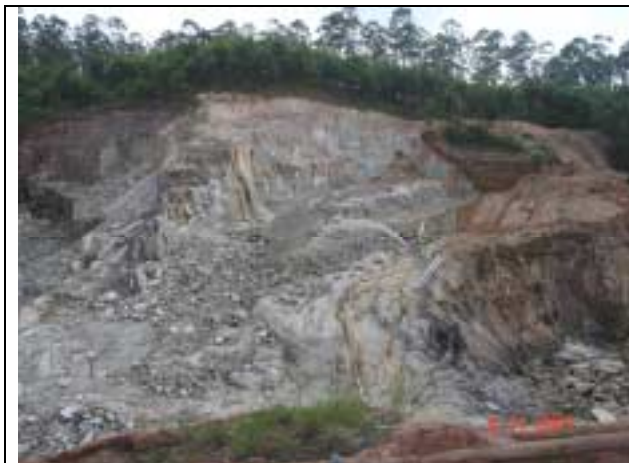
Foto 1 - Frente de lavra por desmonte hidráulico (Extratora de Areia Carmo Messias).
