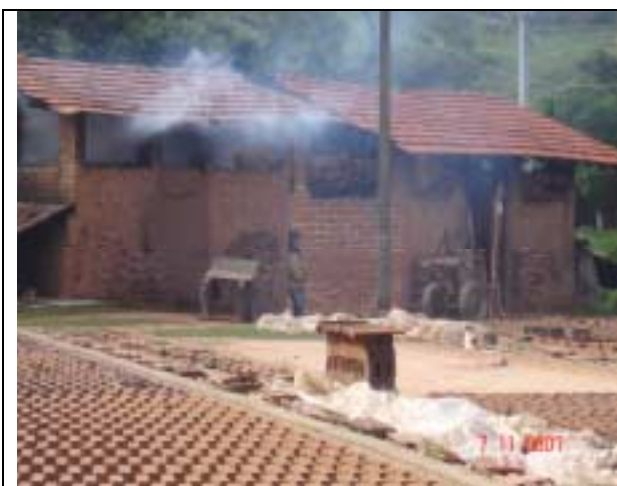
Foto 23 – Pátio aberto para secagem dos tijolos (Olaria Santo Antonio).
