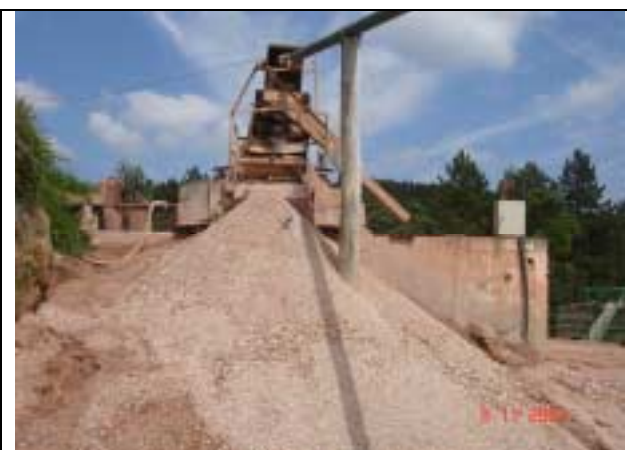
Foto 8 - Sistema de separação de material, destacando-se o rejeito (Extratora Verava).
