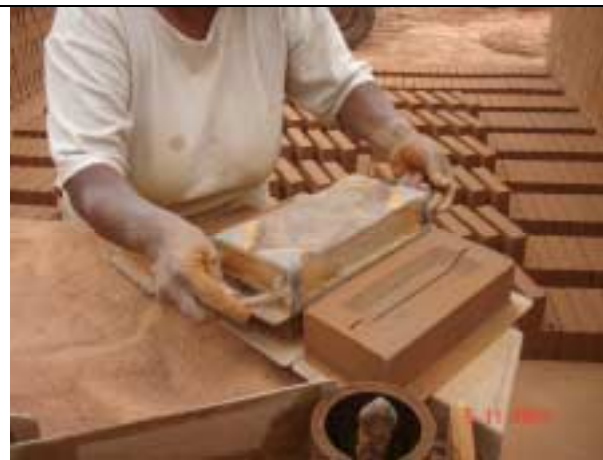
Foto 18 - Forma utilizada na fabricação de tijolos comum e aparente (Tino Olaria).
