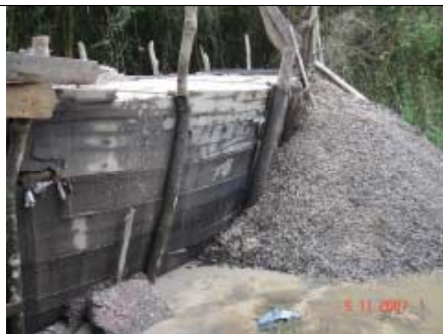
Foto 10 - Caixa com areia fina dragada do rio Sorocabuçu. O material mais grosso é devolvido novamente ao rio.
