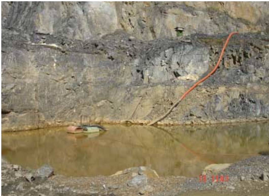
Foto 4 – Bombeamento de água do fundo da cava utilizada em umectação de vias de transporte interno - Pedreira Khouri/Lafarge.
