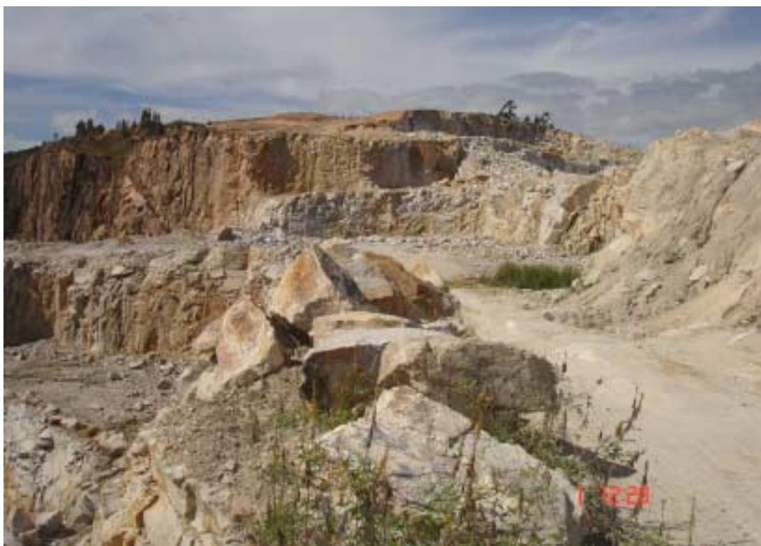
Foto 27 - Sequência de bancadas da frente de lavra atual - Pedreira Anhanguera.
