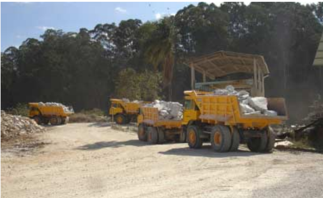
Foto 36 – Fila de caminhões fora-de-estrada para alimentação de britador primário - Pedreira Anhanguera.
