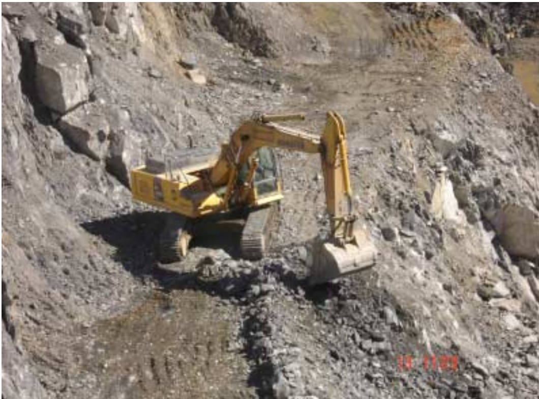
Foto 2 – Escavadeira para operações de carregamento de rocha -Pedreira Khouri/Lafarge.
