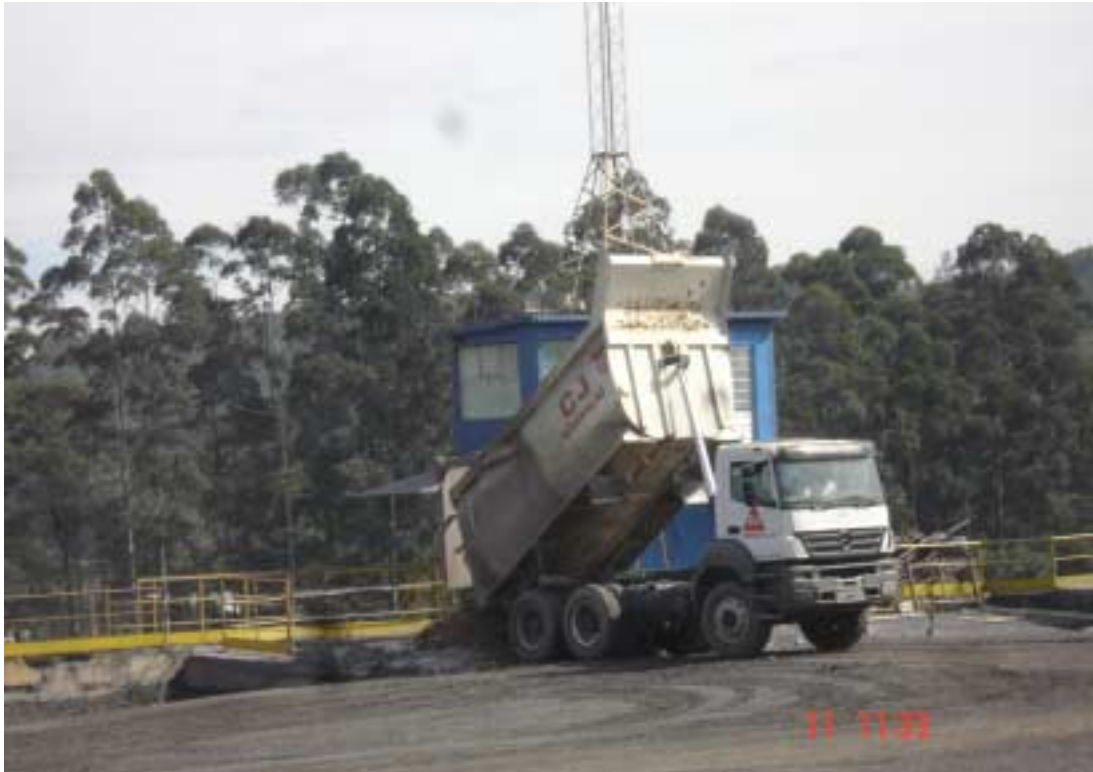
Foto 21 – Alimentação do britador primário para produção de bica corrida - Pedreira CJ / Votorantim.
