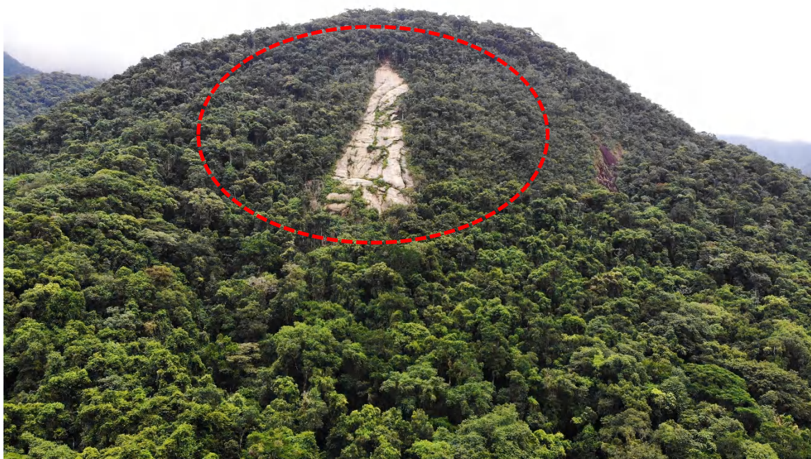
Figura 177: Destaque da área de escorregamento natural recente nas montanhas da bacia hidrográfica do rio Mococa, em área de risco P5 (Perigo Extremo). Imagem aérea de março/2021.
