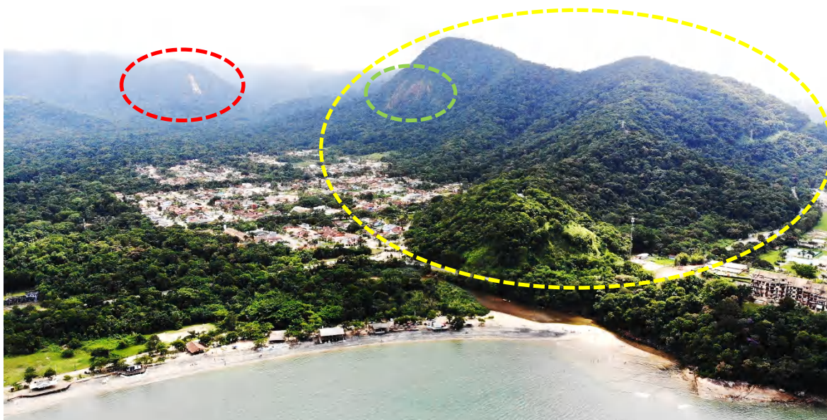
Figura 176: A elipse em amarelo destaca o morro, divisor das bacias hidrográficas dos rios Mococa e Tabatinga, com risco P4 (Perigo Alto) de escorregamentos; a elipse verde, dentro da amarela, demarca um ponto de escorregamento antigo. A elipse em vermelho delimita uma das áreas na bacia hidrográfica do rio Mococa com risco P5 (Perigo Extremo). Dentro deste círculo, destaca-se um escorregamento recente, ampliado na próxima figura. Imagem aérea de março/2021.
