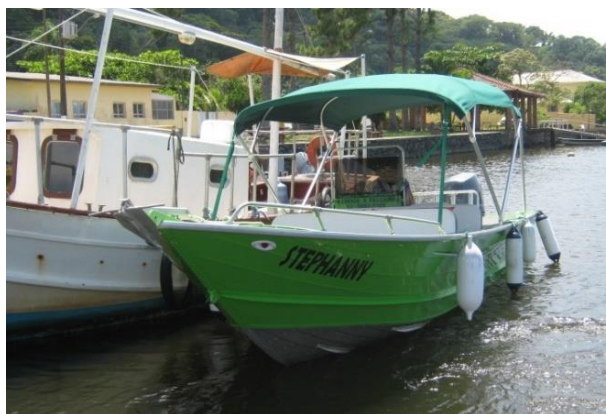
Figura 104 – Voadeira de alumínio de costado alto comumente utilizada na pesca amadora embarcada costeira na APAMLS. Fonte: FF/FUNDEPAG (2015).
