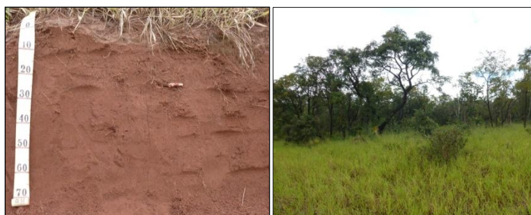
Apêndice 2.3.3F. (A) Corte de Latossolo Vermelho (LV) de textura média e cor 2,5YR 3/6. (B) Encontrado no terço superior da vertente em área de cerradão com Eucalipto e Pinus, desenvolvido de arenito.
