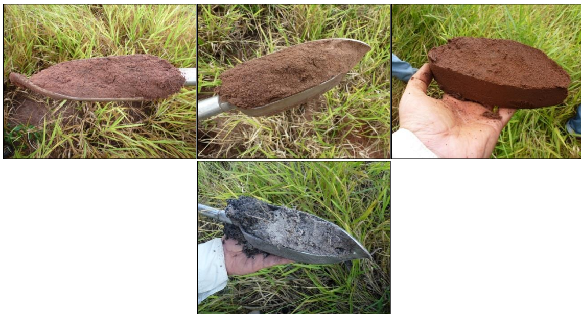
Apêndice 2.3.3K. Neossolo Quartzarênico. (A) Cor 5YR \frac{3}{4} na profundidade 70cm, na baixa vertente. (B) Cor 7,5YR 4/3, profundidade 50cm, na baixa vertente. (C) Horizonte arenoso na profundidade de 70cm, terço médio a inferior de rampa. (D) Cor acinzentada do horizonte C, na baixa vertente.
