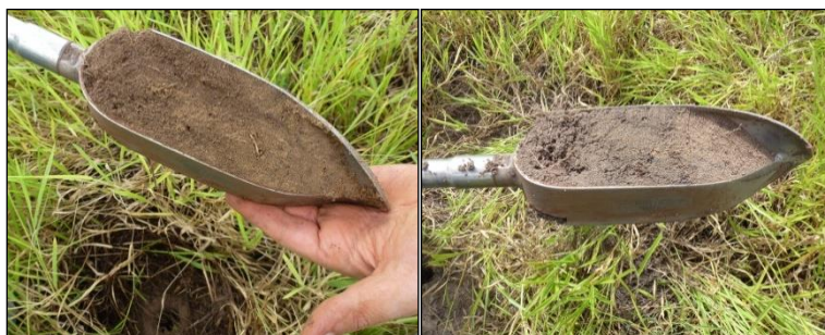
Apêndice 2.3.3G. (A) Argissolo Acinzentado de textura arenosa/média grosseira e cor 10YR 6/4 em profundidade de 100cm. (B) Na profundidade de 130cm verificou-se acúmulo de argila e textura média mais fina.
