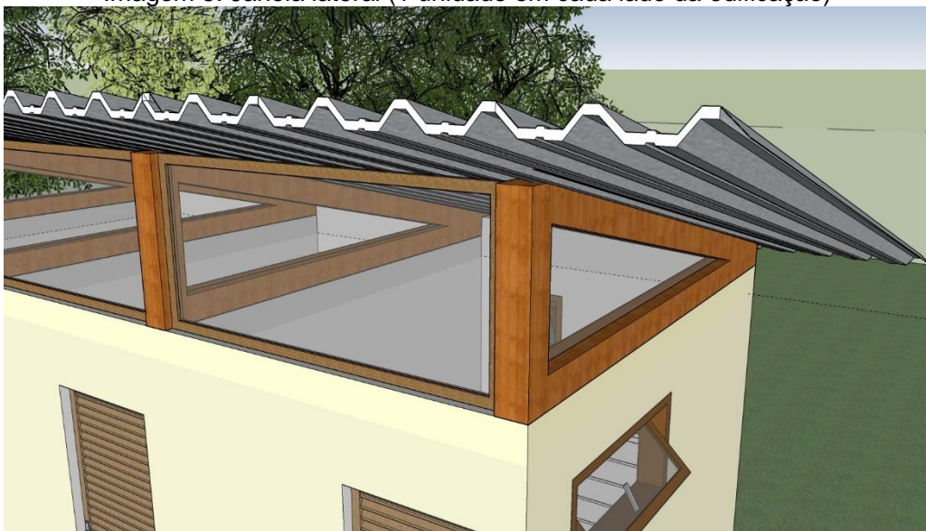
Imagem 6. Detalhes dos caixilhos sob a cobertura
