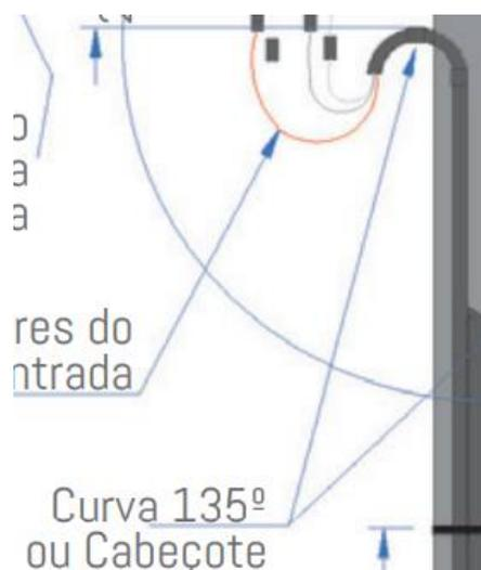
**Figura 4** – Eletroduto PVC rígido roscado com curva 135°
