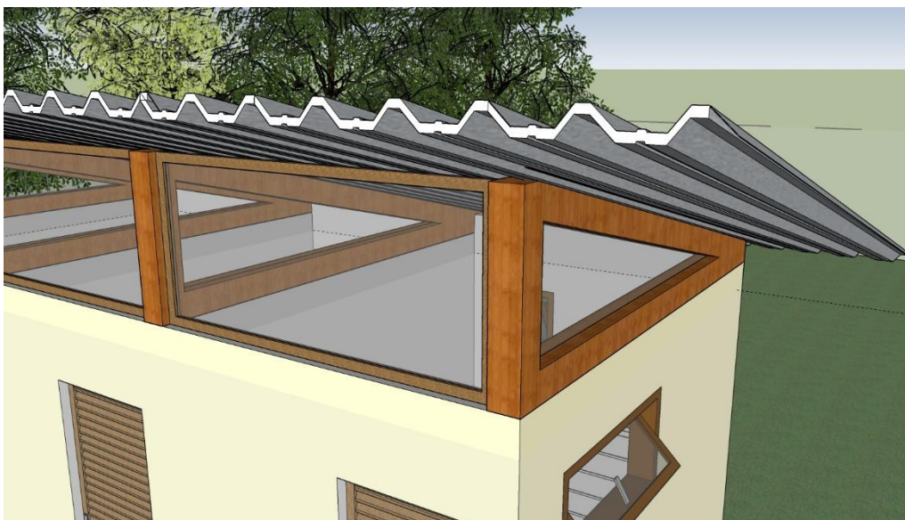
Imagem 6. Detalhes dos caixilhos sob a cobertura
