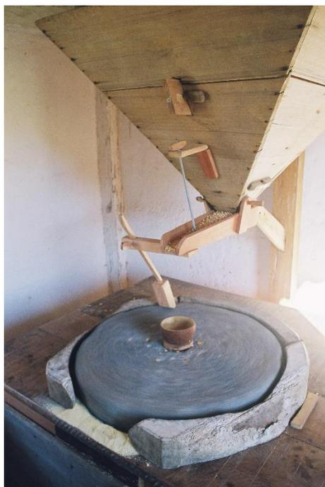
Foto 3: Exemplo do funil de faces retas a ser executado e instalado sobre a moenda
