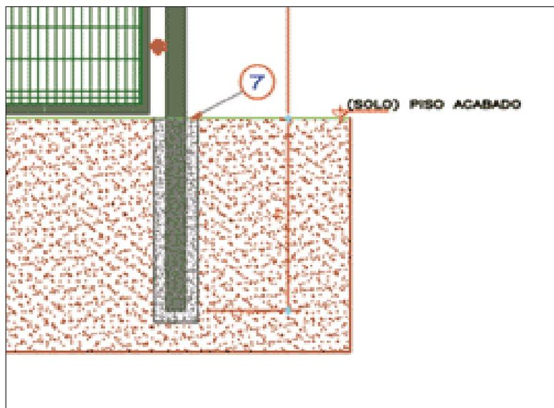
Figura 6:fixação dos pilaretes com concreto
