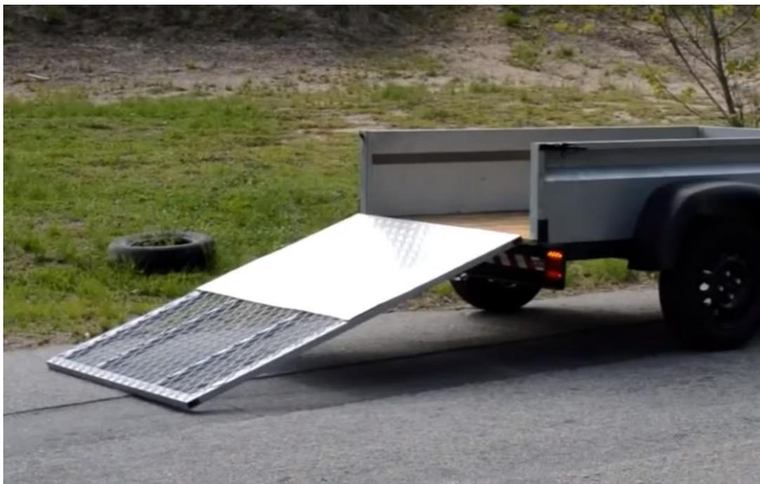
**Figura 2** – Imagem ilustrativa da tampa basculante para carretinha
