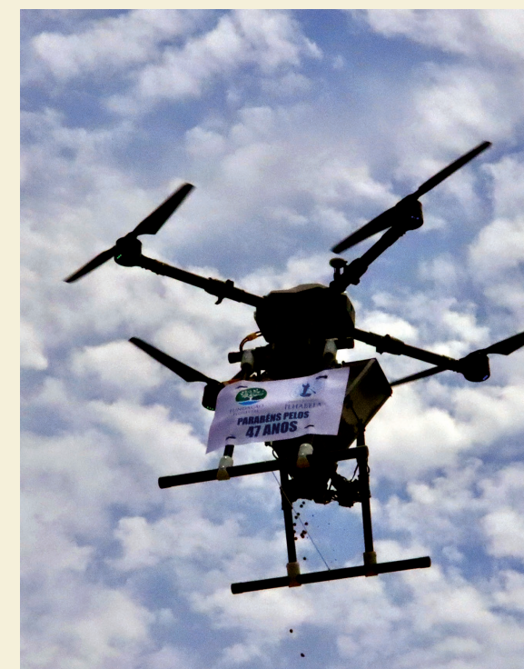
Drone desenvolvido especificamente para o projeto, realizando dispersão de sementes no PE Ilhabela. Fotos: Acervo FF.
