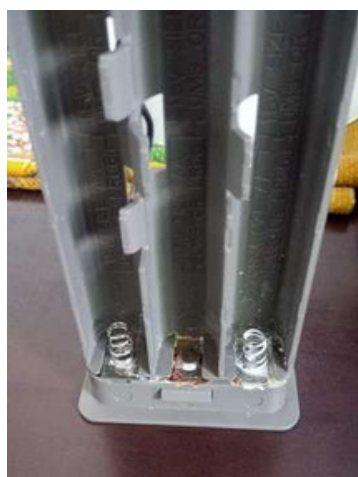
Armadilhas fotográficas danificadas, por vazamento de pilha (esq.) e por javaporcos (dir.)
