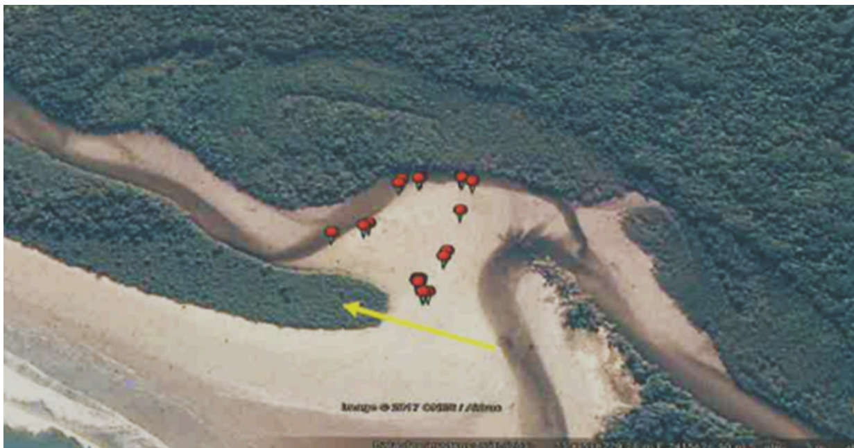
Figura 5.6. Escrube em estágio avançado (indicado pela seta).
