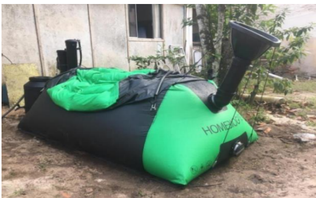
Figura 11: Biodigestor em processo de instalação, com o gasômetro ainda inoperante. Fonte: Silva Junior, 2021.
