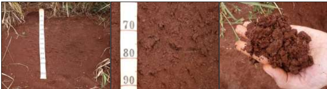
Apêndice 2.3.3I. (A) Perfil de Nitossolo Vermelho (NV); (B) Detalhe de NV no qual é possível notar a estrutura do solo ainda no perfil; (C) Amostra de NV que demonstra a estrutura em blocos.
