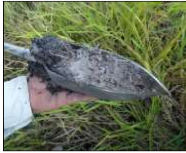
Apêndice 2.3.3K. Neossolo Quartzarênico. (A) Cor 5YR \frac{3}{4} na profundidade 70cm, na baixa vertente. (B) Cor 7,5YR 4/3, profundidade 50cm, na baixa vertente. (C) Horizonte arenoso na profundidade de 70cm, terço médio a inferior de rampa. (D) Cor acinzentada do horizonte C, na baixa vertente.
