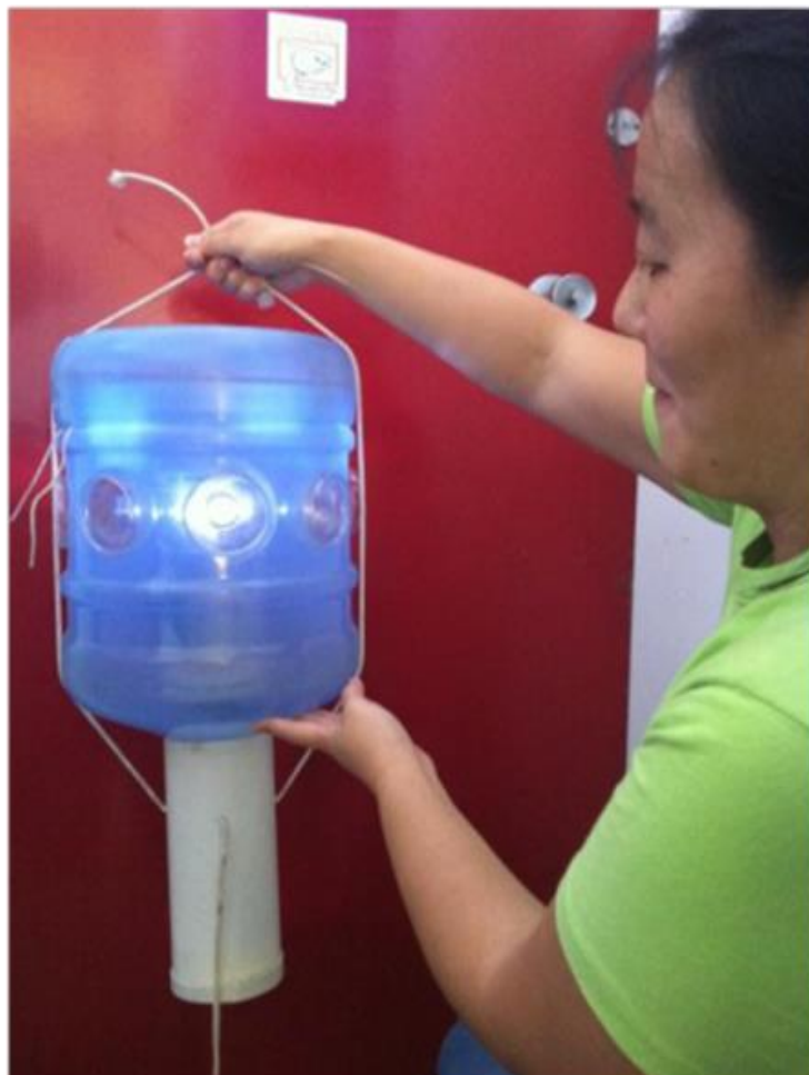
Figura 20 - Armadilha de luz utilizada na coleta de larvas e mero plâncton confeccionada com material reciclado e iluminação LED feito no Laboratório de Instrumentação Oceanográfica do IO-USP. Fonte: ANRAKU, 2012.
