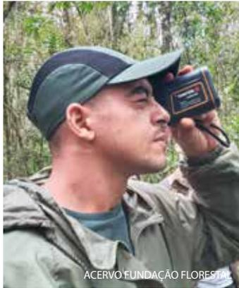
Todas as **medidas devem ser registradas de forma precisa**. Para isso, deve-se utilizar um hipsômetro/telômetro, aparelho digital capaz de medir distâncias, ou uma trena manual para que não haja erros significativos nos dados de medição.
