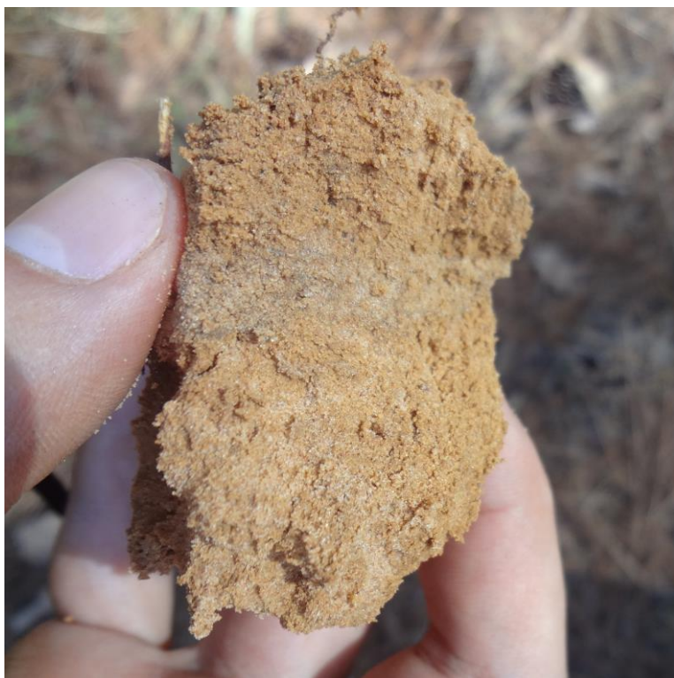
Figura 4 - Ponto 47. Amostra de Latossolo-Vermelho Amarelo argissólico. Notar regiões mais esbranquiçadas de concentração arenosa (outubro-2013/ César Canhadas.)
