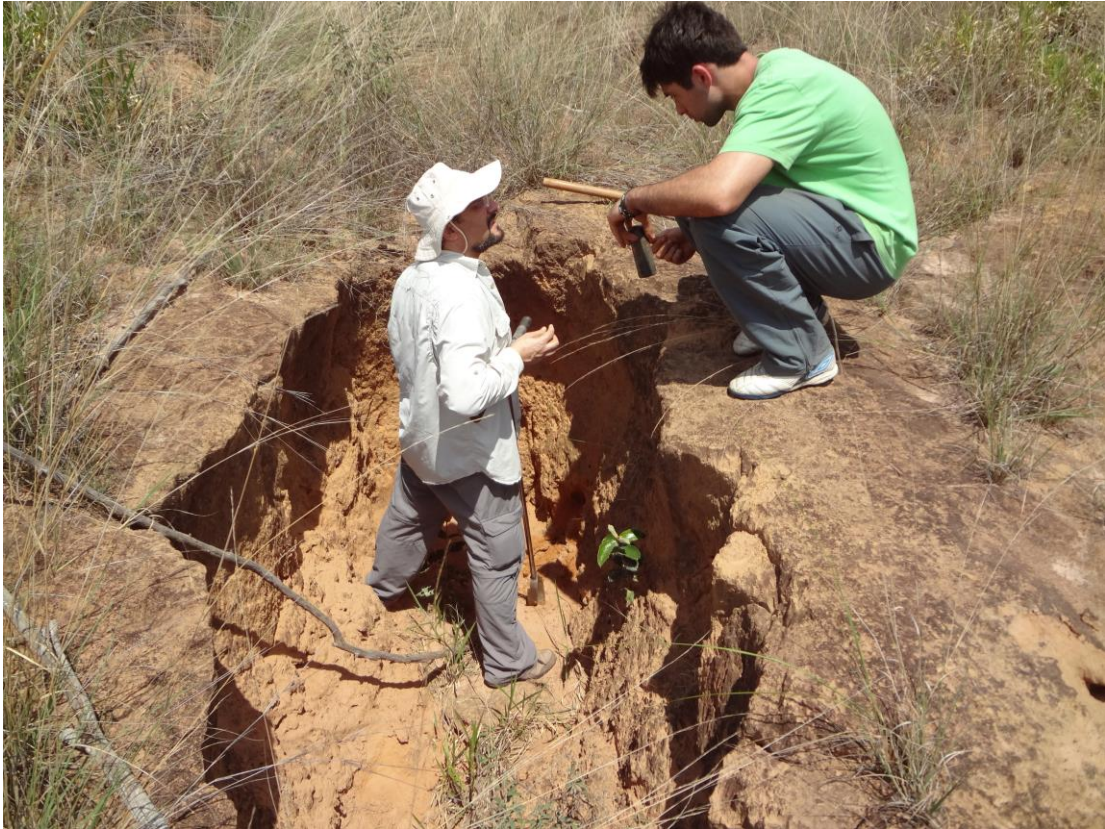
Figura 8 - Ponto 20. Evolução do processo erosivo, em sulco profundo. (outubro-2013/ César Canhadas.)
