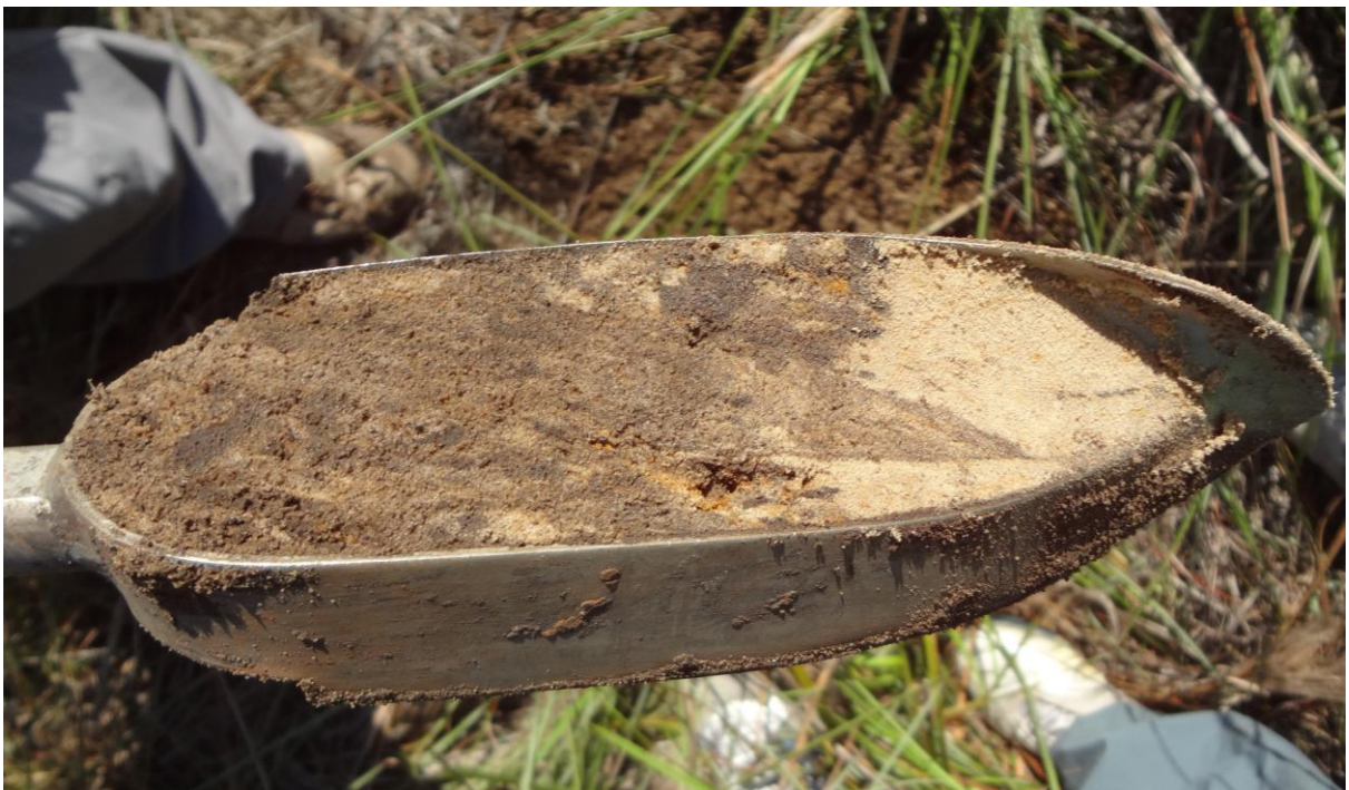
Figura 2 - / Ponto 10. Amostra de Neossolo Quartzarênico hidromórfico típico, retirada da calha temporariamente seca do curso d'água. Há alternância entre as camadas superficiais com matéria orgânica e areia. (outubro-2013/ César Canhadas.)
