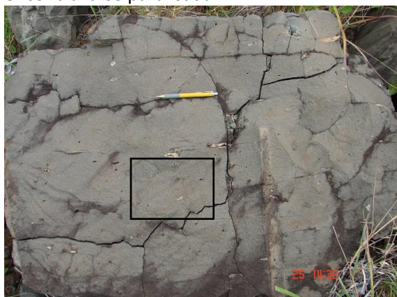
Figura 4: Bloco rolado de basalto maciço cinza escuro com presença de geodos e amígdalas preenchidas por sílica, carbonato e zeólita, além da presença de fragmento arredondado de basalto com gotas de material vítreo (melhor observado na foto de detalhe à direita).
