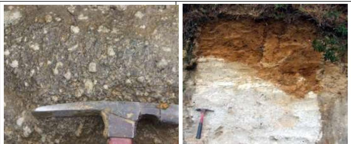
Fotos 67 e 68 – Hornblenda-biotita gnaíse migmatítico do Complexo Quirino, com porfiroblastos de plagioclásio e hornblenda como máfico principal, que apresentam solo de alteração areno-silto-argiloso e solo residual argiloso que constituem os Terrenos Montanhosos e Escarpados.
