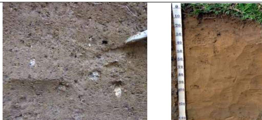
Fotos 5 e 6 - Sedimento areno-argiloso, homogêneo com grânulos de quartzo anguloso, que originam Cambissolo Háplico Tb/Ta eutróficos ou distróficos textura média quase sempre associado ao Neossolo Flúvico e Gleissolo Háplico, na Planície Fluvio-coluvial do Rio do Braço, que constitui os Terrenos Detriticos Fluvio-coluviais.
