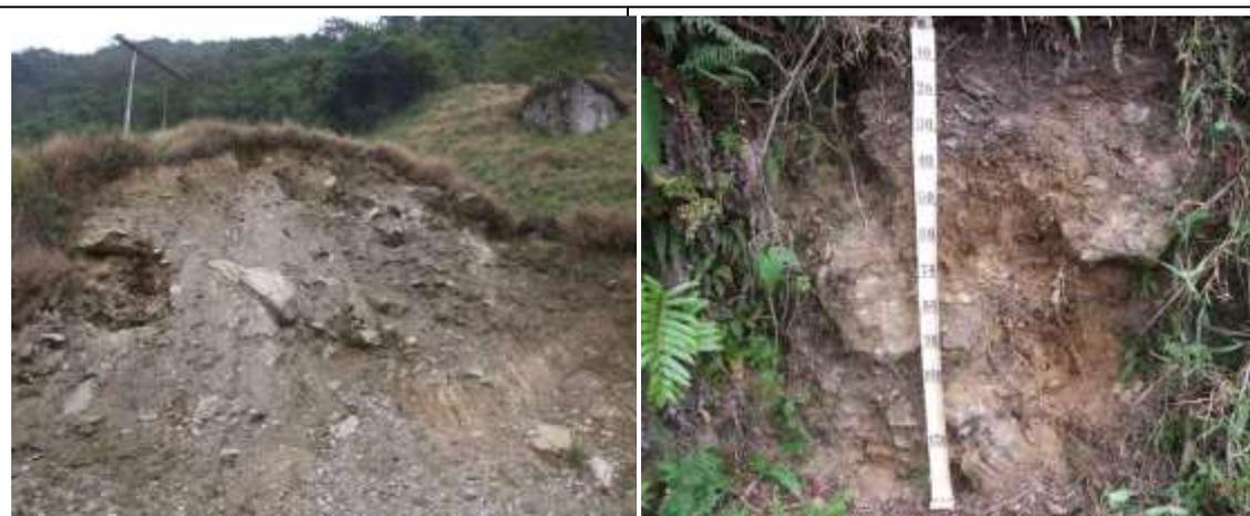
Fotos 47 e 48– Blocos e matacões angulosos em matriz argilo-arenosa rica em fragmentos de muscovita leucogranito fortemente foliado, que constituem Corpo de Tálus gerados por processos erosivos gravitacionais e pluviais do tipo movimentos de massa, em que se destacam os escorregamentos e as quedas de bloco. Esses depósitos associam-se a Cambissolo Háptico Tb pedregosos ou não e rochosos ou não distróficos textura média e argilosa.
