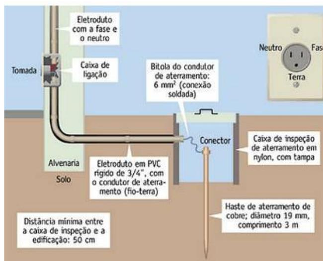
**Figura 04** – Exemplo aterramento do padrão de entrada
