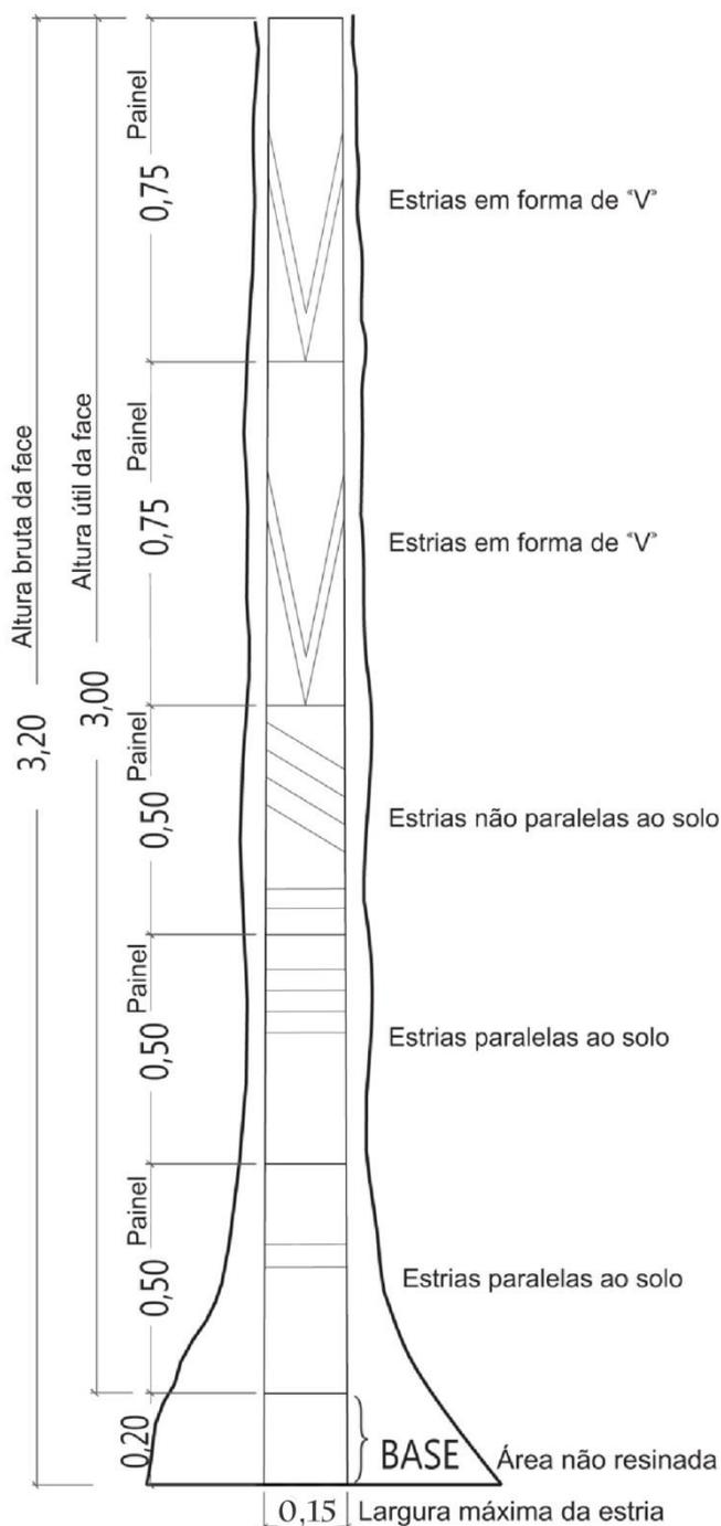
FACE - o lado da árvore onde vão ser instalados os painéis.
