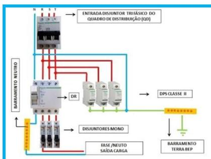
Figura 04 – Dispositivo DR para ligação FFN.
