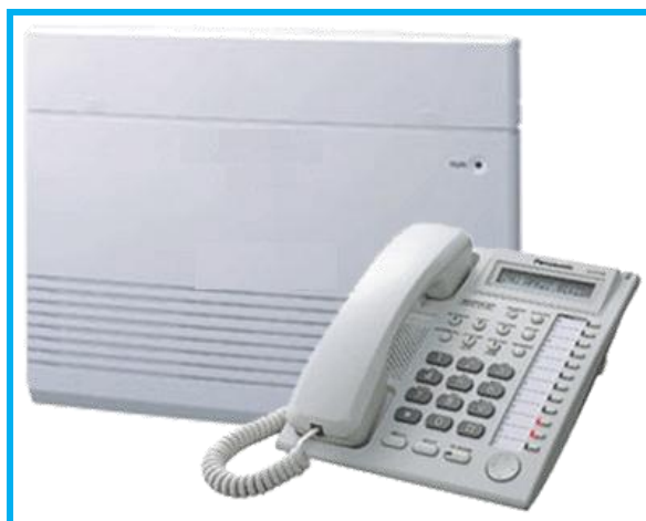
Figura 2 – Exemplo de PABX com terminal inteligente (KS).
