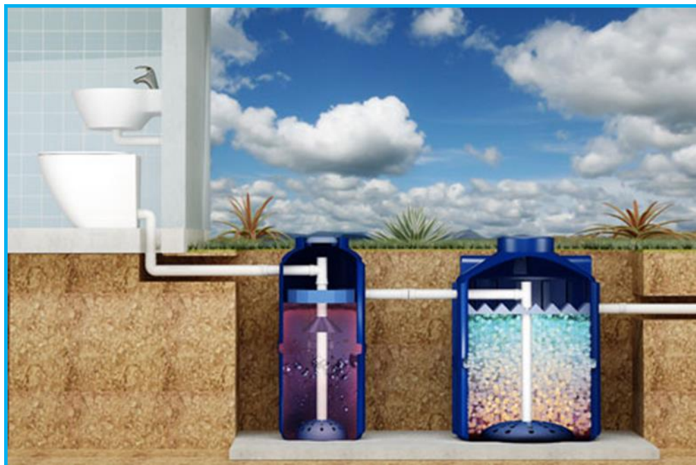
Figura 3 – Exemplo de ETE Compacta.
