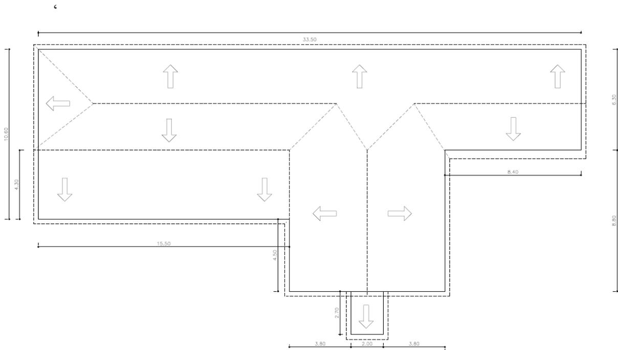
Desenho 1 – Disposição dos telhados e fluxo da água
