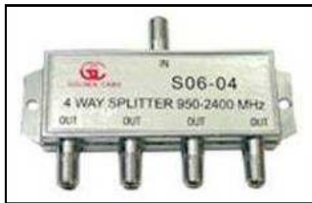
Figura 23– Divisor de frequência com saída para quatro receptores.
