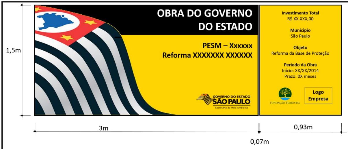
*Figura 1 – Exemplo de Placa de Obra.*
