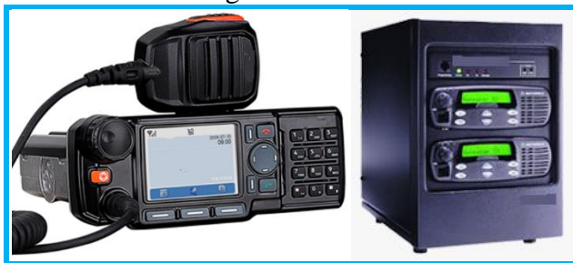
Figura 4 – Exemplo de estação móvel e gabinete.
