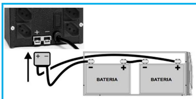
Figura 7 – Exemplo de ups com bateria externa.
