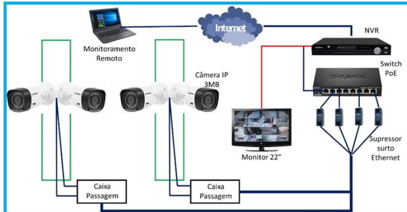
Figura 8 – Esquema de ligação dos equipamentos.
