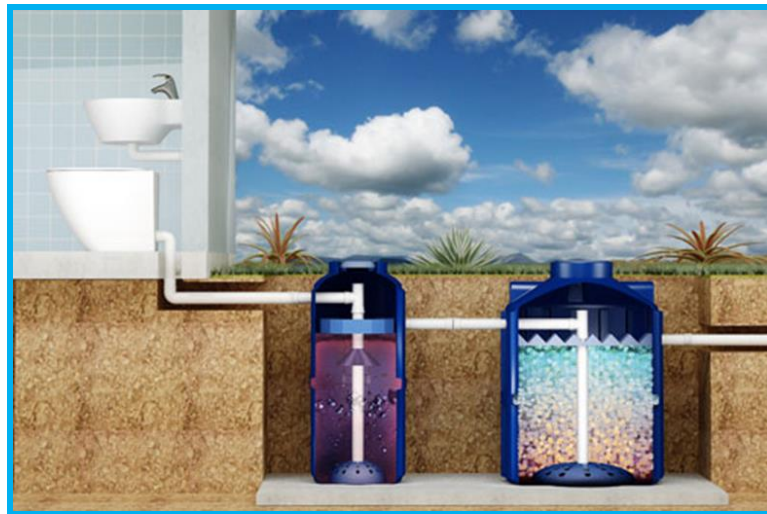
Figura 3 – Exemplo de ETE Compacta.
