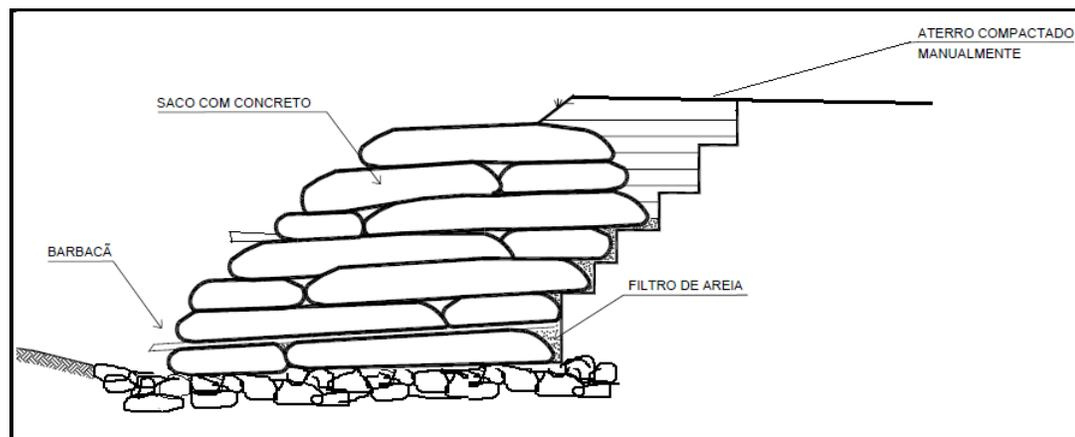
Figura 4 - Forma de assentamento das bolsas de concreto.
