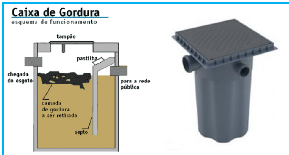
Figura 6 – Exemplo de caixa de gordura.
