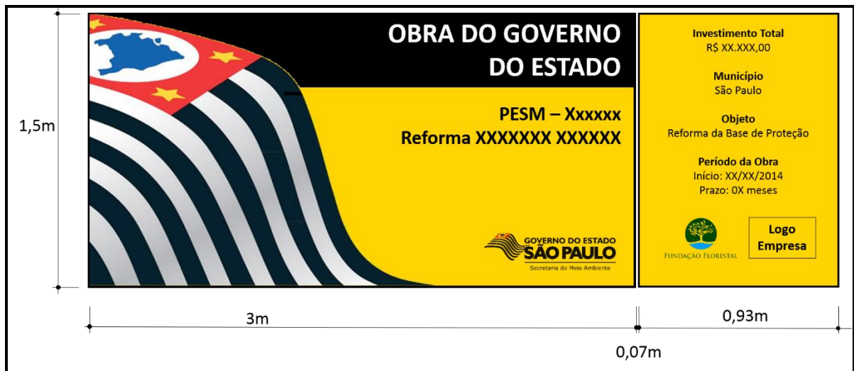
Figura 1 – Exemplo de Placa de Obra.
