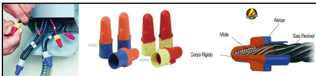
Figura 8 – Conectores elétricos para emenda de chuveiro e aquecedores.
