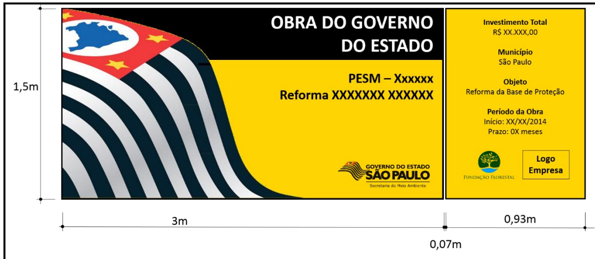
Figura 8 – Exemplo de Placa de Obra.
