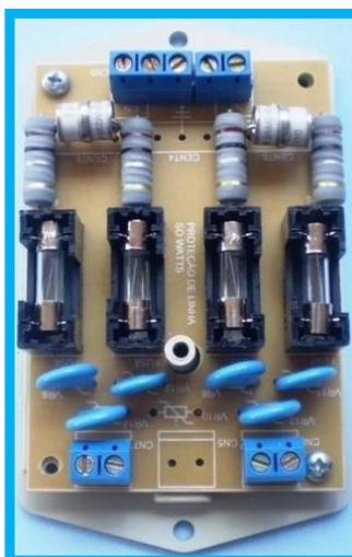
Figura 3 - Exemplo de protetor de linha telefônica.
