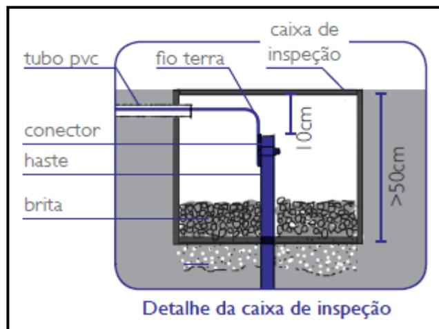
Figura 6 – Sistema de aterramento.
