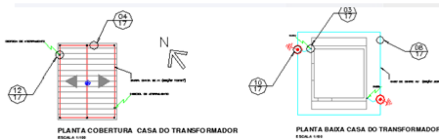
Figura 36 – Projeto SPDA casa do transformador
