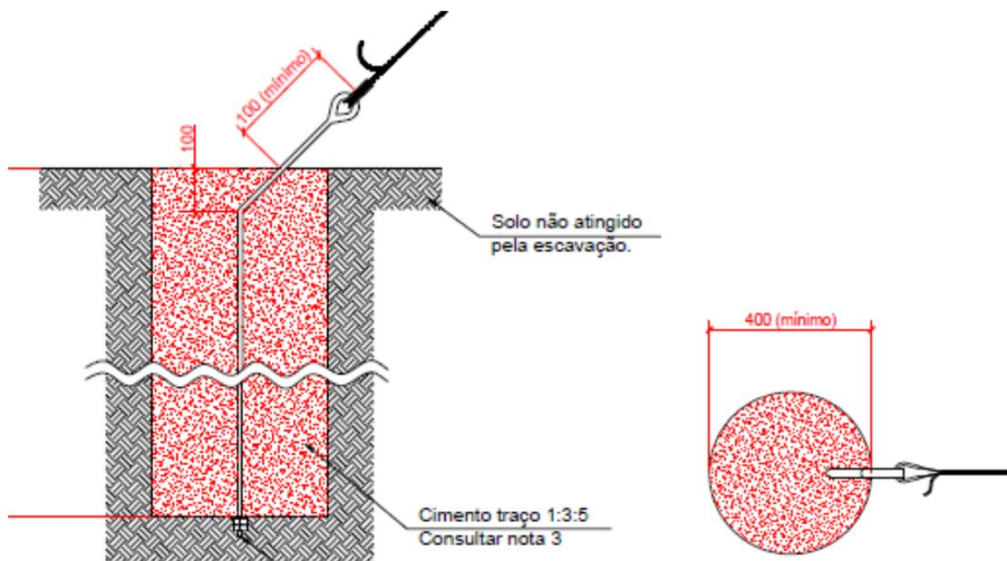
Figura 1 – Detalhe da broca e do estai (corte e planta)
