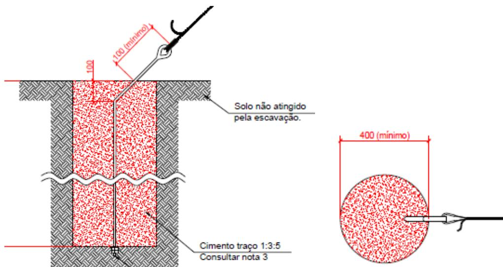
Figura 2 – Detalhe da broca e do estai (corte e planta)
