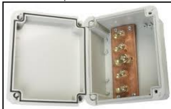
Figura 5 – Caixa de equipotencialização. Deverá possuir elemento de fixação de cabos em sua entrada, conhecido como “prensa cabos”, deverão ainda possuir porta documentos e plaqueta de identificação dos circuitos, todos os cabos deverão possuir conector apropriados para a fixação nos disjuntores, sendo estes prensados ou soldados e identificados por anilhas plásticas.
