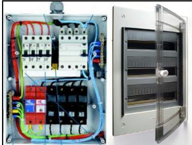
Figura 4 – Quadros de distribuição horizontal em aço ou material plástico. O barramento do condutor de proteção (terra) será eletricamente ligado ao barramento de equipotencialização principal e ao condutor neutro. A saída dos condutores deste quadro será feita por meio de eletrodutos de PVC rígido.
