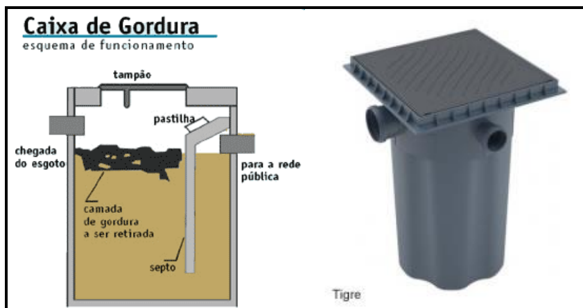
Figura 3 – Exemplo de caixa de gordura.
