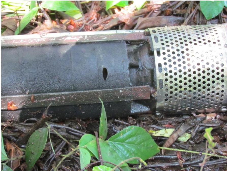
**Figura 5:** Detalhe do furo que inutilizou a bomba.
