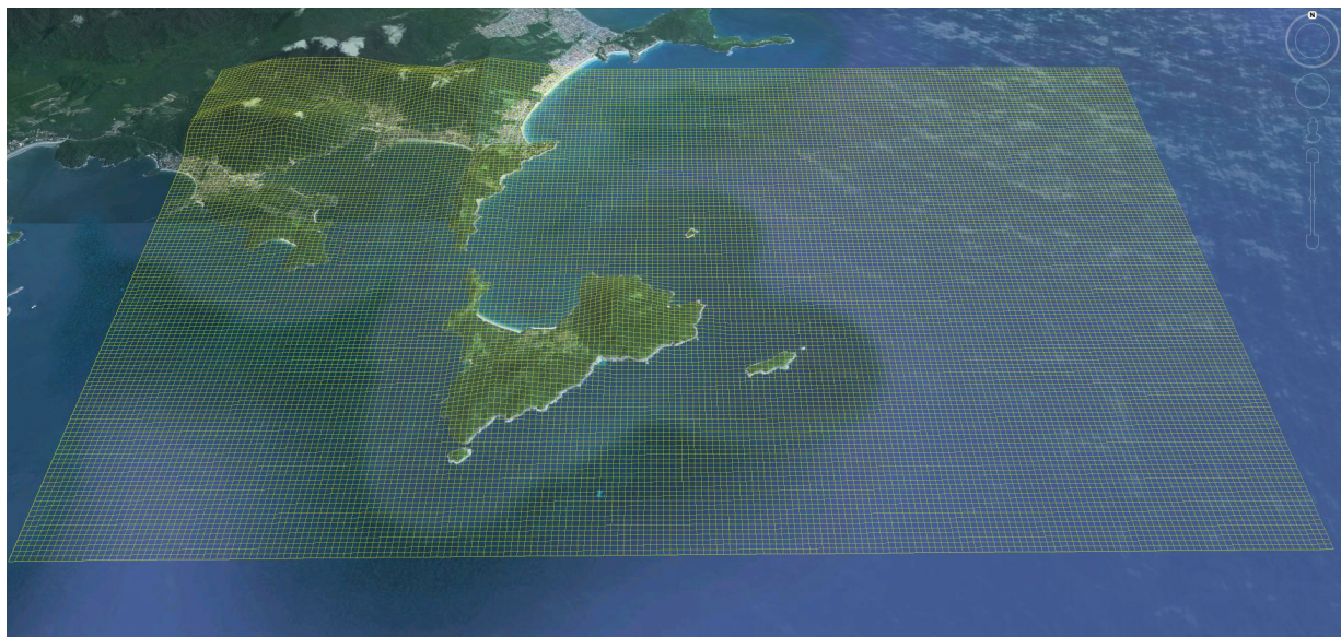
Figura 3.3. Imagem da grade numérica e do domínio utilizado na modelagem numérica de ondas, plotada sobre o mapa da região. A imagem está distorcida devido ao tamanho da figura, de baixa resolução.
