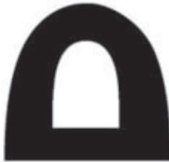
Figura II.2. Desenho e geometria da defesa do fabricante ANDINO MARÍTIMA do tipo VD-100.
