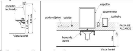
Figura 3: acessórios junto ao lavatório
