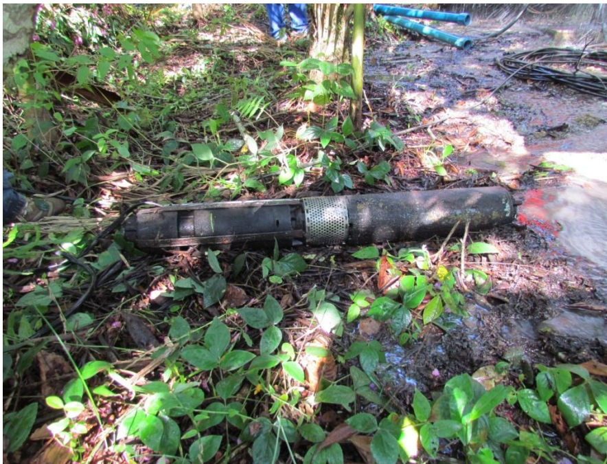
Figura 4: Bomba d'água retirada do poço.
