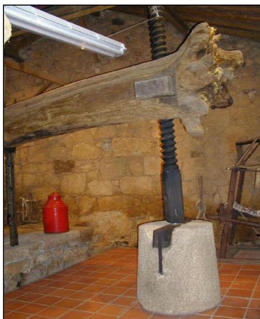
Fig. 139: Prensa de parafuso com a base idêntica à existente no sítio Ruínas do Guarauzinho, com a fenda na parte central superior e furos nas laterais, para fixação. O Parafuso regulava a pressão aplicada. Museu Etnográfico e Cultural de Ninho do Açor, Portugal. Site http://ninhodoacor.blogspot.com
