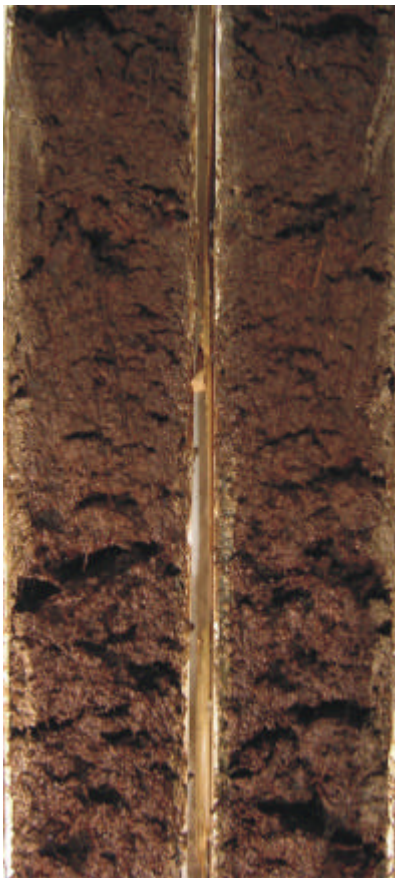
Figura 24. Turfa "leve ou fibrosa" a "escura ou hêmica" em testemunho coletado em sondagem com vibrotestemunhador no PECE (S01-UTM 215638N/7271581E) (Sallun et al. 2008)
