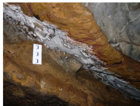
Foliação da rocha encaixante exibindo camada com presença de sulfetos
